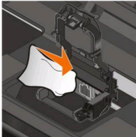
**Aviso: Danos potenciais:** Não toque no filtro de tinta da cabeça de impressão nem nos ejetores da cabeça de impressão.
