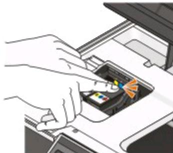
**Nota:** Instale os novos tinteiros imediatamente após a remoção da protecção para evitar a exposição da tinta ao ar.
